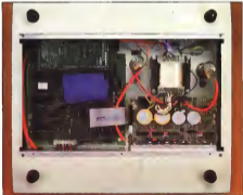
VISTA DALL'INTERNO. Si notano oltre all'altissimo livello di schede che gestisce i comandi di scheda gli interventi di gestione ROM e dei tre microprocessori Z80 e, in alto, la scheda del microprocessore KS 732.
